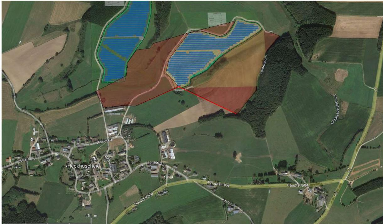
Abbildung 12: mögliche horizontnahe Reflexionswinkel der östlichen PV-Fläche in Rot
