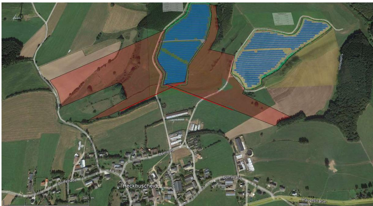
Abbildung 13 mögliche horizontnahe Reflexionswinkel der westlichen PV-Fläche in Rot
