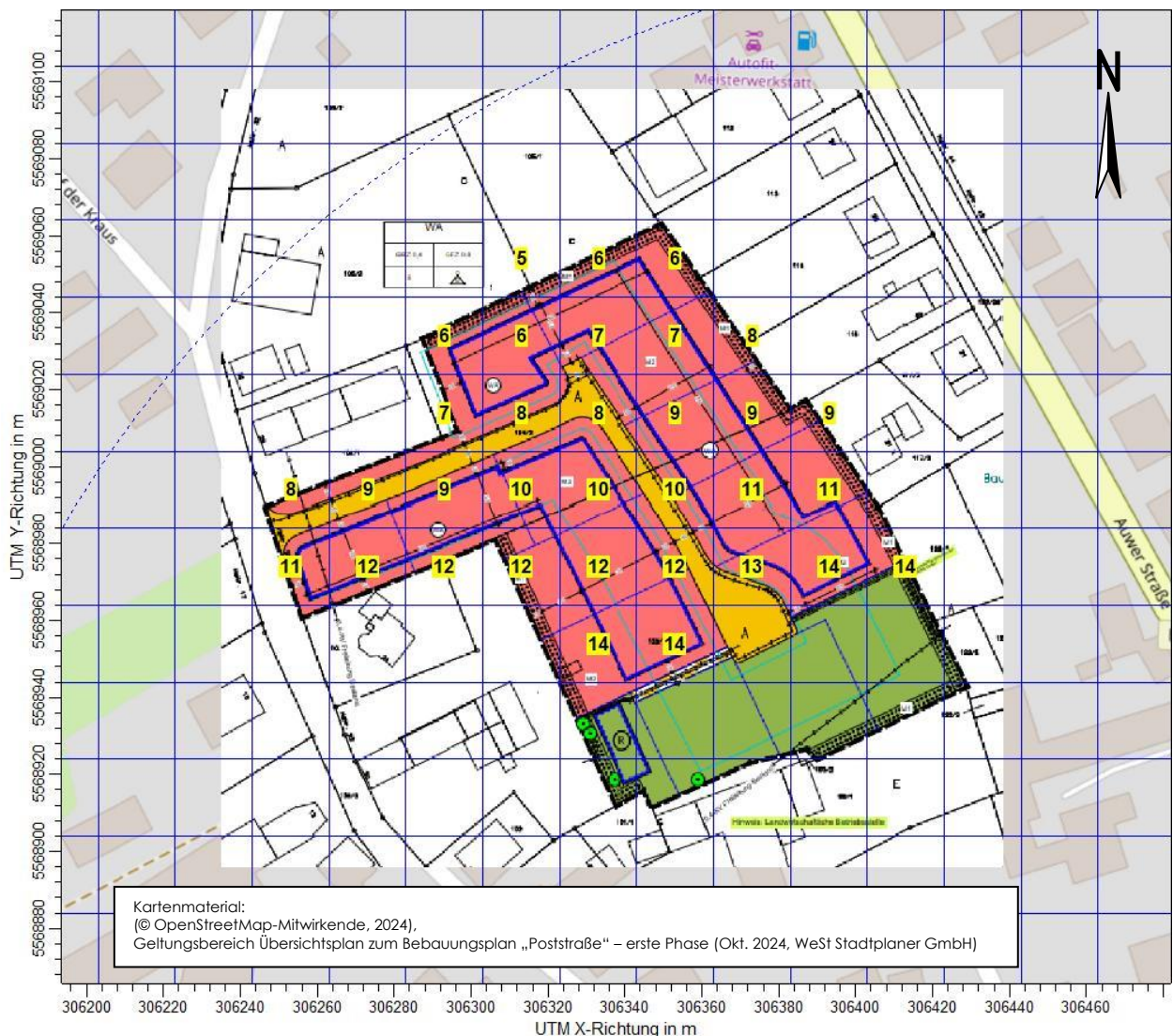
Abbildung 5: Gesamtbelastung IG_b durch die Betriebe A1 – A8 und A10 in % der Jahresstunden, Seitenlänge: 20A m
