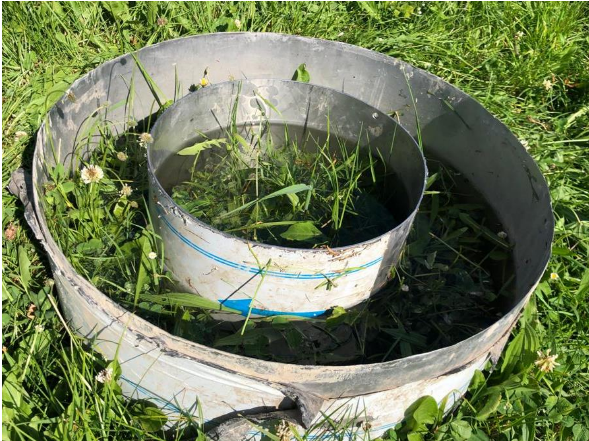
Abbildung 2 - Doppelringinfiltrometer Versuch auf der Fläche (P14).
