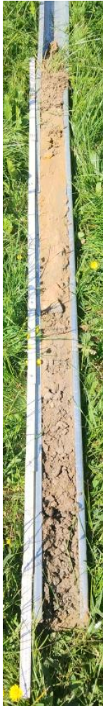
Bodenkerne in herausgezogenen, z.T. verformte Rammprofile
