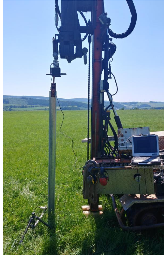
Vorbereitung axialer Zugversuch
