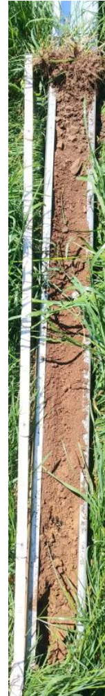
Bodenkerne in herausgezogenen, z.T. verformte Rammprofile
